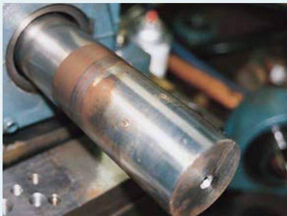
Corrosión por fricción y daño al eje típicos con el cojinete de tornillo de fijación
