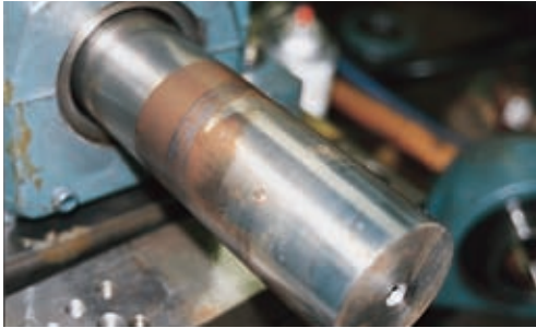
Cojinete de tornillo de fijación tras 500 horas
