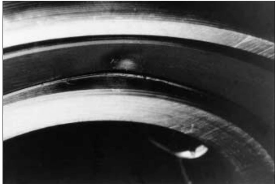
98: Obturación abollada con arañazos
