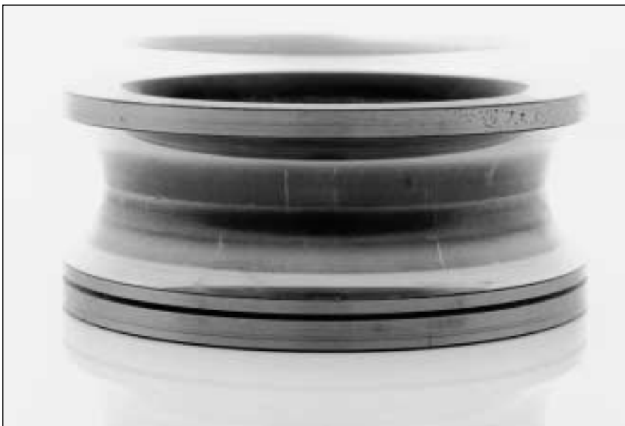
28: Huella de rodadura con desgaste superficial
