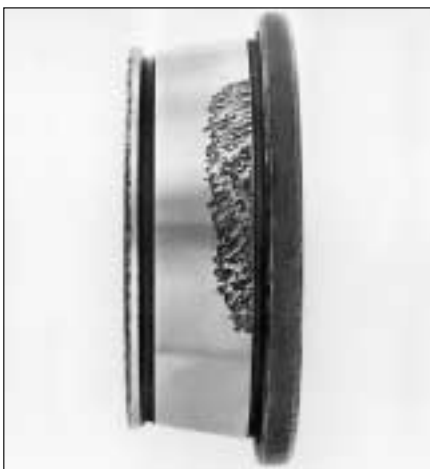
40: Huella de rodadura ladeada en un rodamiento de rodillos cónicos
