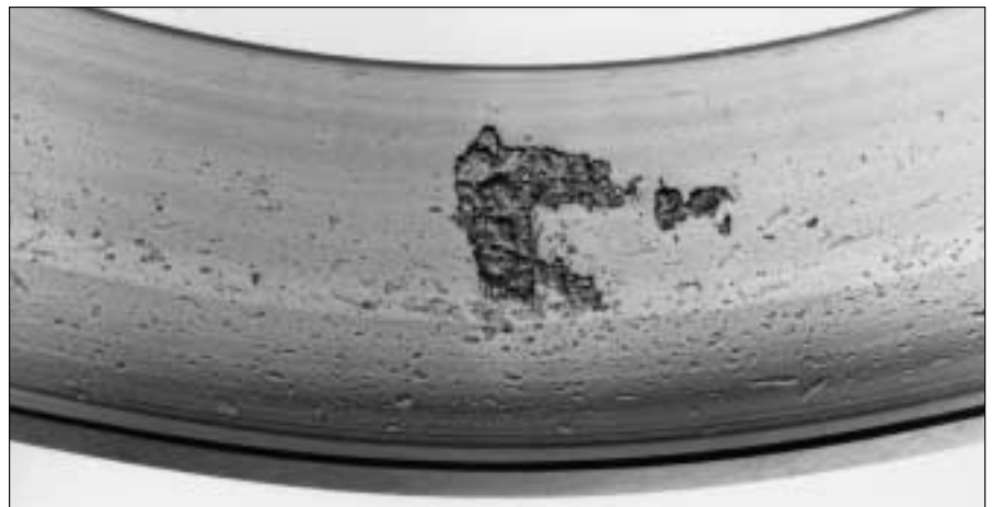
43: Deterioro por fatiga en el camino de rodadura del aro exterior de un rodamiento de rodillos cónicos
