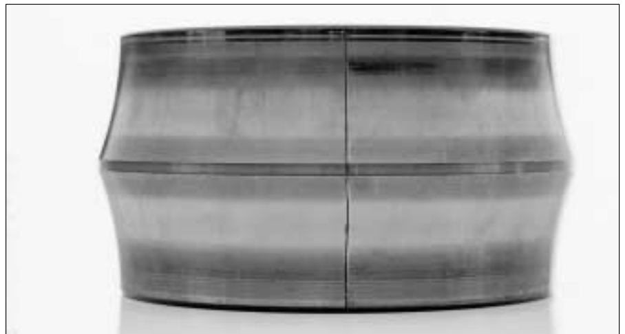
64: Rotura axial del aro interior de un rodamiento oscilante de rodillos
