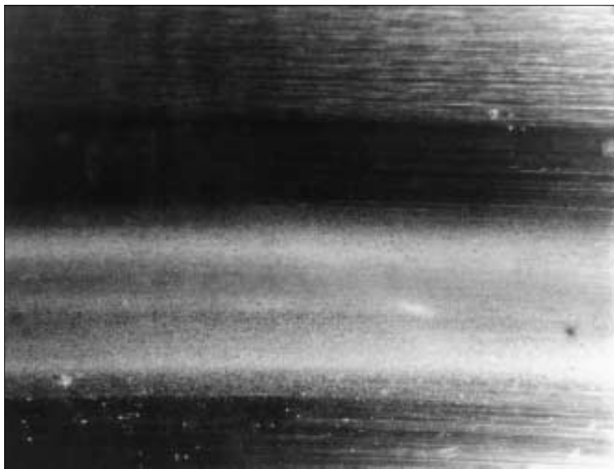
66: Camino de rodadura gastado, rugoso
