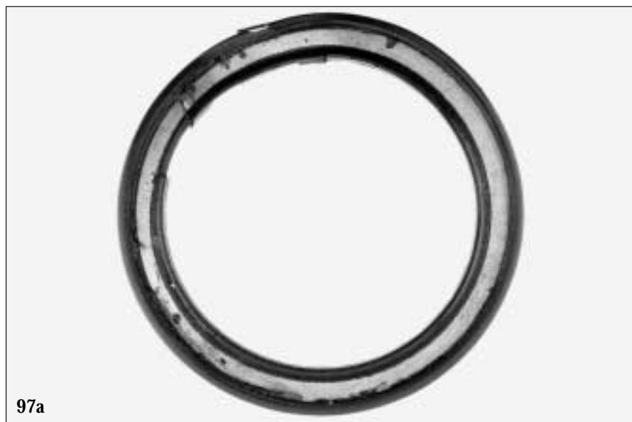
97a: Obturación endurecida con desgaste y roturas b: Detalle de un labio de obturación gastado
