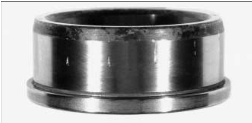
76: Estrías longitudinales en el camino de rodadura del aro interior de un rodamiento de rodillos cilíndricos producidas por un montaje con ladeo con los elementos rodantes
