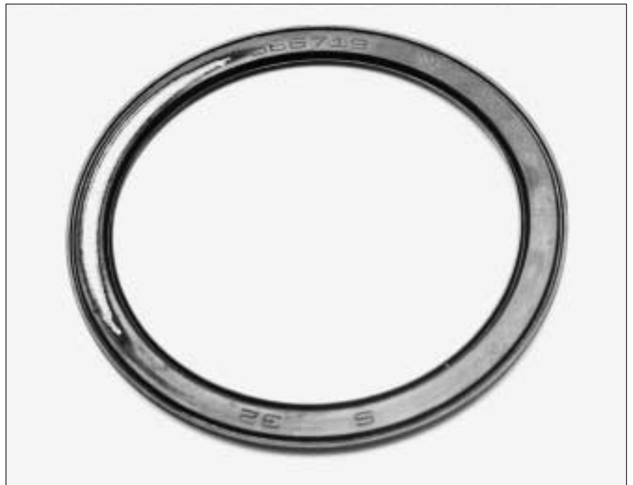
22: Deterioro de la obturación por rozamiento lateral
