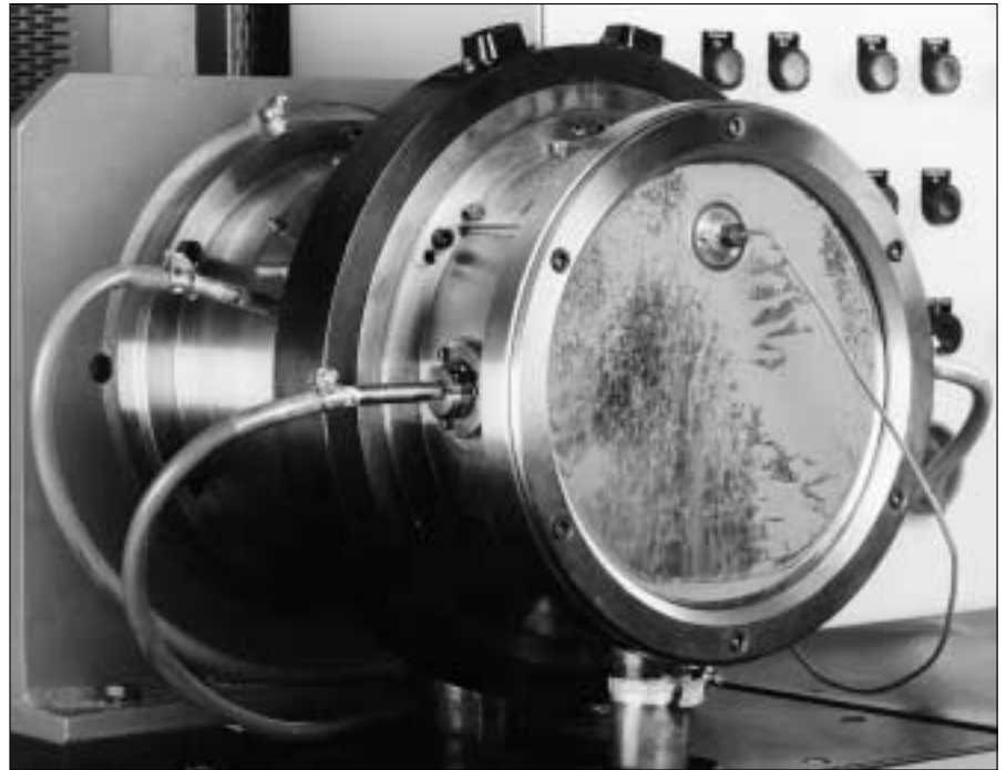
114: Banco de pruebas para el ensayo de la eficacia de obturaciones en rodamientos
