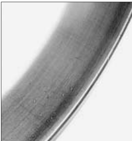
23: Huella de rodadura normal; la estructura superficial todavía es visible, y sólo se encuentran algunas impresiones aisladas producidas por cuerpos extraños
