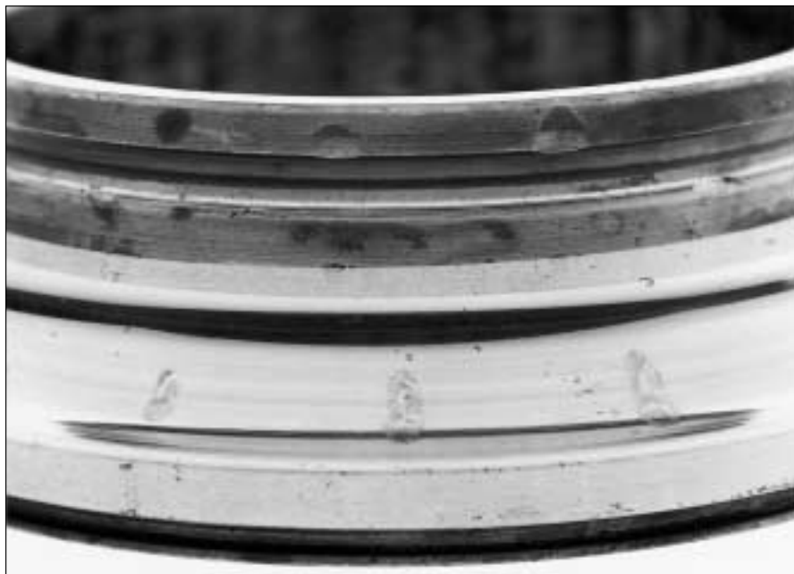
57: Falso brinelling en un rodamiento de bolas
