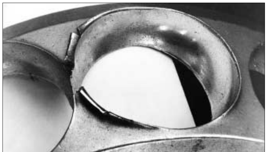
91: Debido al lado de los aros entre sí, se han generado fuerzas de reacción elevadas entre las bolas y la jaula, que tendrían como consecuencia la rotura de la costilla
