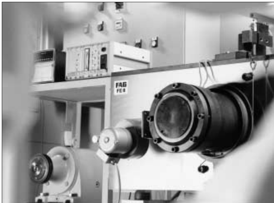
107: Banco de pruebas para la determinación de la calidad de los lubricantes
