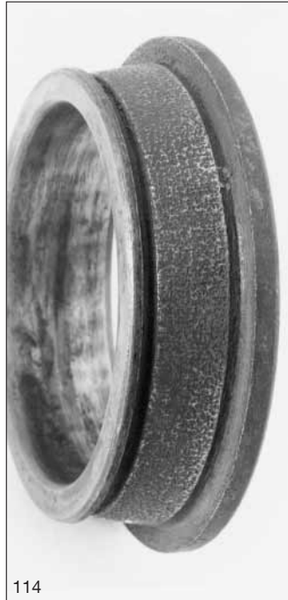
114: Daños producidos por oxidación en el aro interior de un rodamiento de rodillos cónicos.
