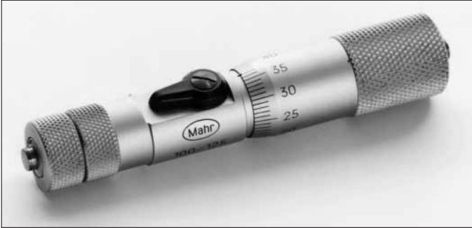
4: Con el micrómetro de interiores se miden los agujeros.
